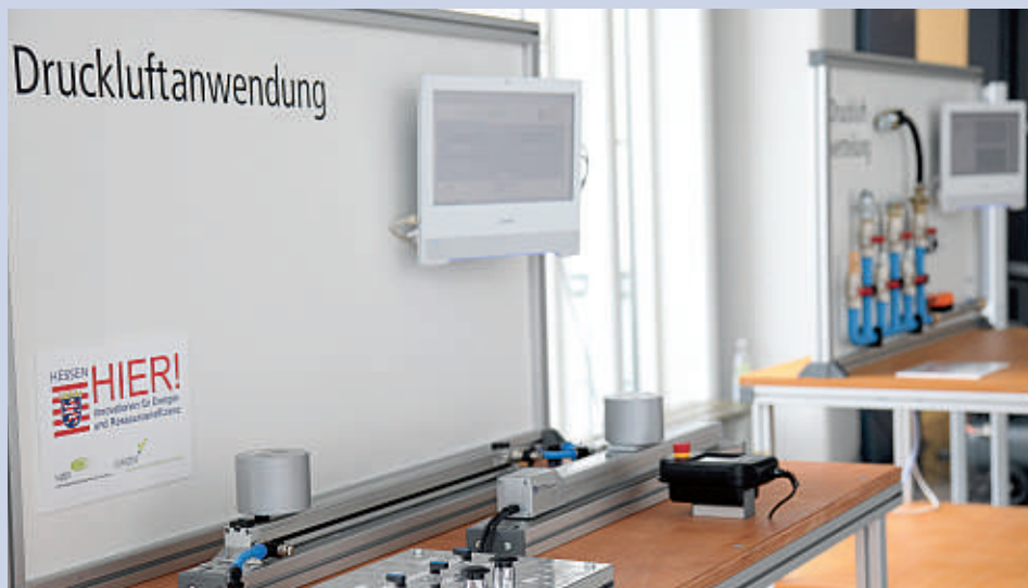
Anschauliches Modell: Auf der linken Schiene wird ein 4,5 Kilogramm schweres Gewicht mit Druckluft bewegt. Rechts ist ein Motor mit 24 Volt im Einsatz, der im Vergleich eine Ersparnis von 97 Prozent erreicht. (Fotos: nh)
