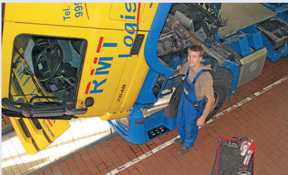
Routine: Viktor Schmies setzt an der Sattelzugmaschine das Lenkgetriebe instand. (Fotos: Junker)
