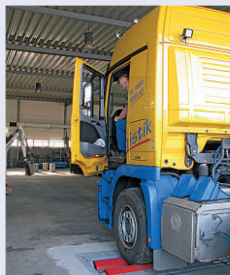
Service in Borken: Fuhrparkleiter Björn Otys, Kfz-Meister, bringt die Sattelzugmaschine auf den Bremsenprüfstand.
